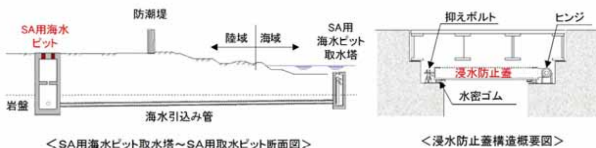
図4.2 SA用海水ピット開口部浸水防止蓋構造概要図
