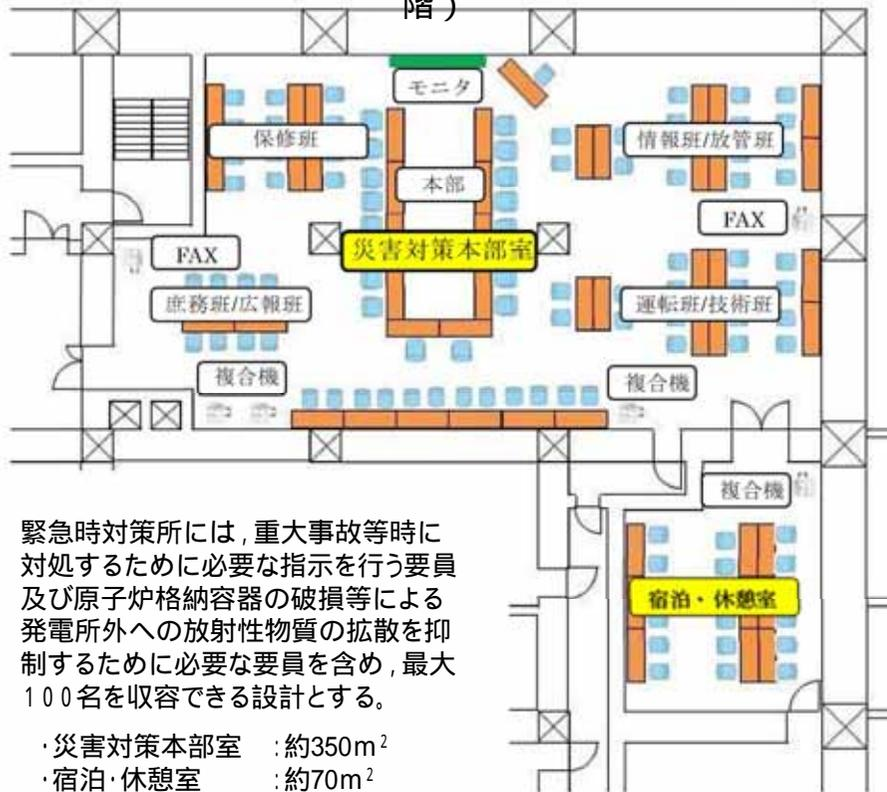
緊急時対策所には、重大事故等に対処するために必要な指示を行う要員及び原子炉格納容器の破損等による発電所外への放射性物質の拡散を抑制するために必要な要員を含め、最大100名を収容できる設計とする。
