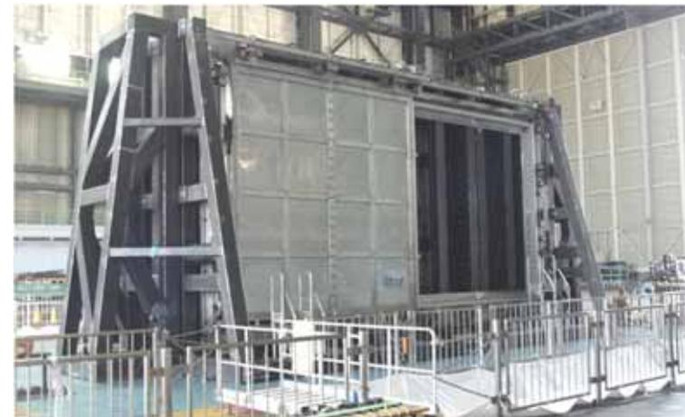
【参考】閉止装置加振試験装置
