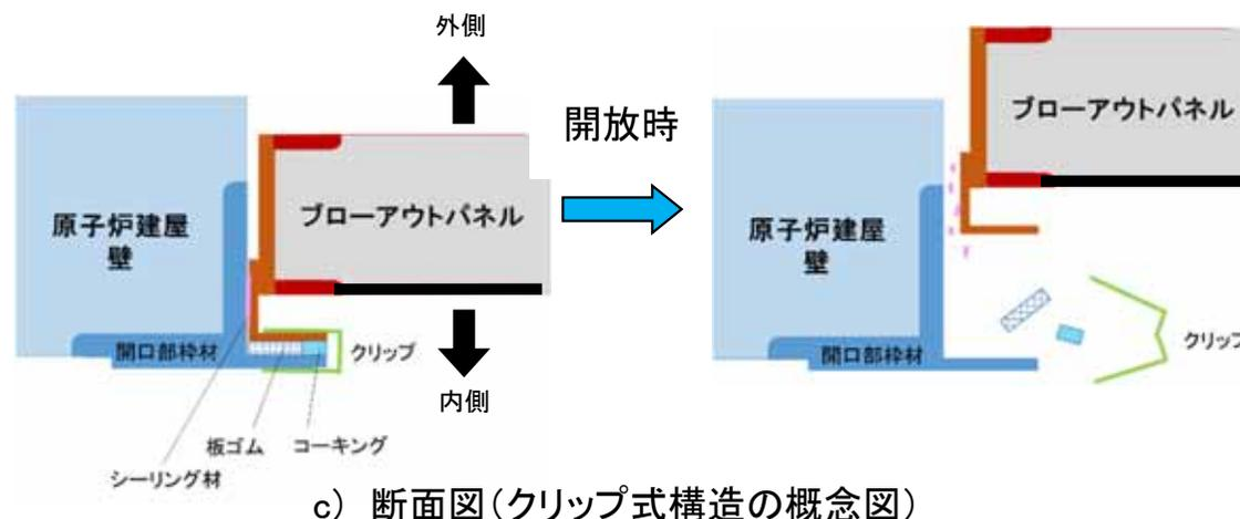
c) 断面図 (クリップ式構造の概念図)
