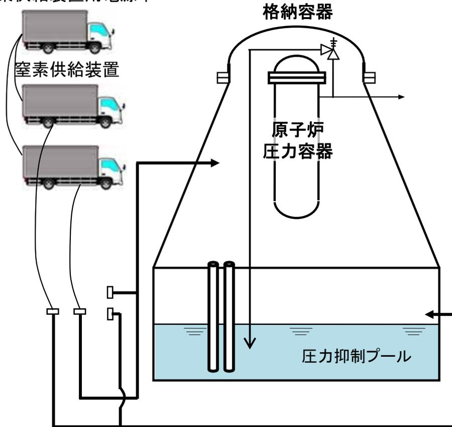
窒素供給装置の系統概要図
