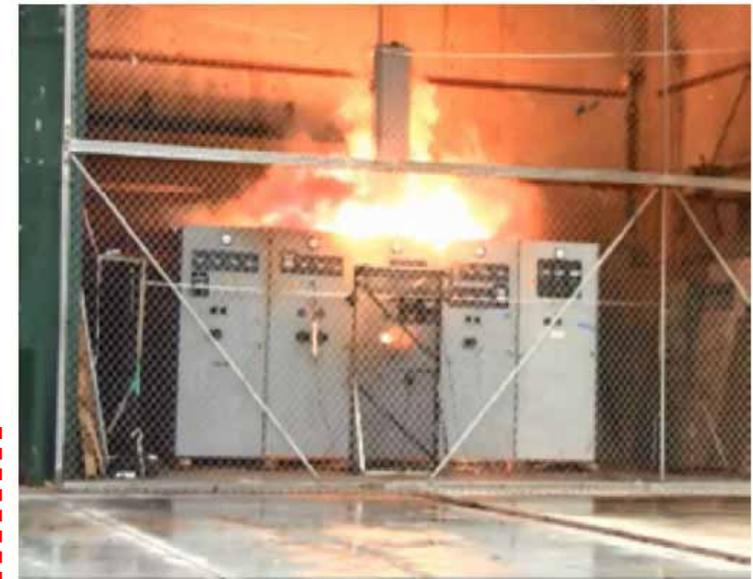
HEAF試験 高圧電源盤のアーク放電・火災発生状況
