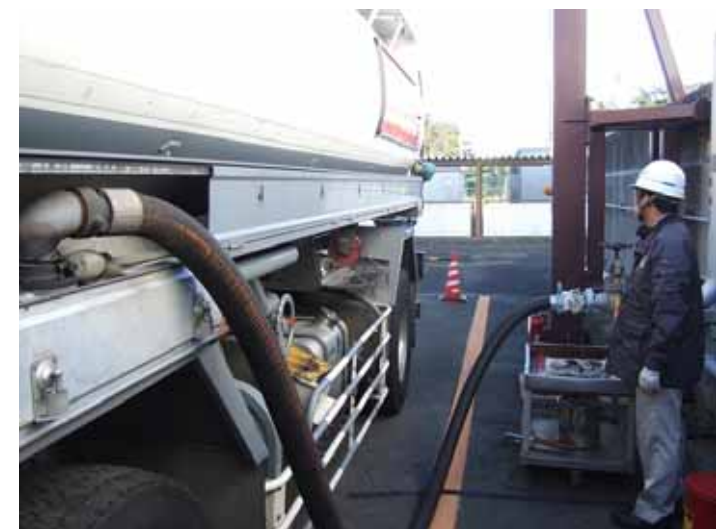
タンクローリーによる発電所への燃料受入状況 (平成23年当時の写真ではない)
