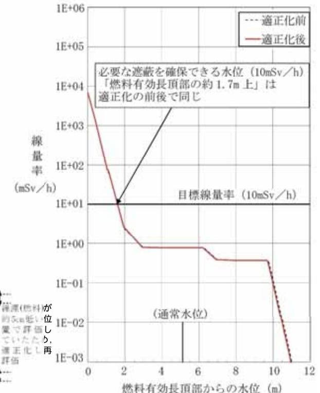
図-2 原子炉水位と線量率の関係
