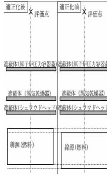
図-1 燃料の線量率計算モデル
