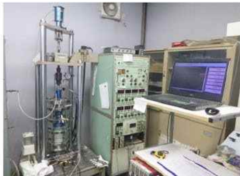
液状化強度試験状況 (中空繰返しねじりせん断試験)
