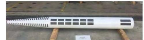
①飛翔体衝突実験に用いた飛翔体
