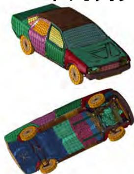
○鉄筋コンクリート壁(壁厚さ3ケース)に竜巻飛来物として車両(乗用車, 質量2t, 速度47m/s)を衝突させたシミュレーション結果が公開されている。
