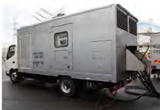
可搬型代替低圧電源車外観及びタービン建屋内での配置イメージ図
