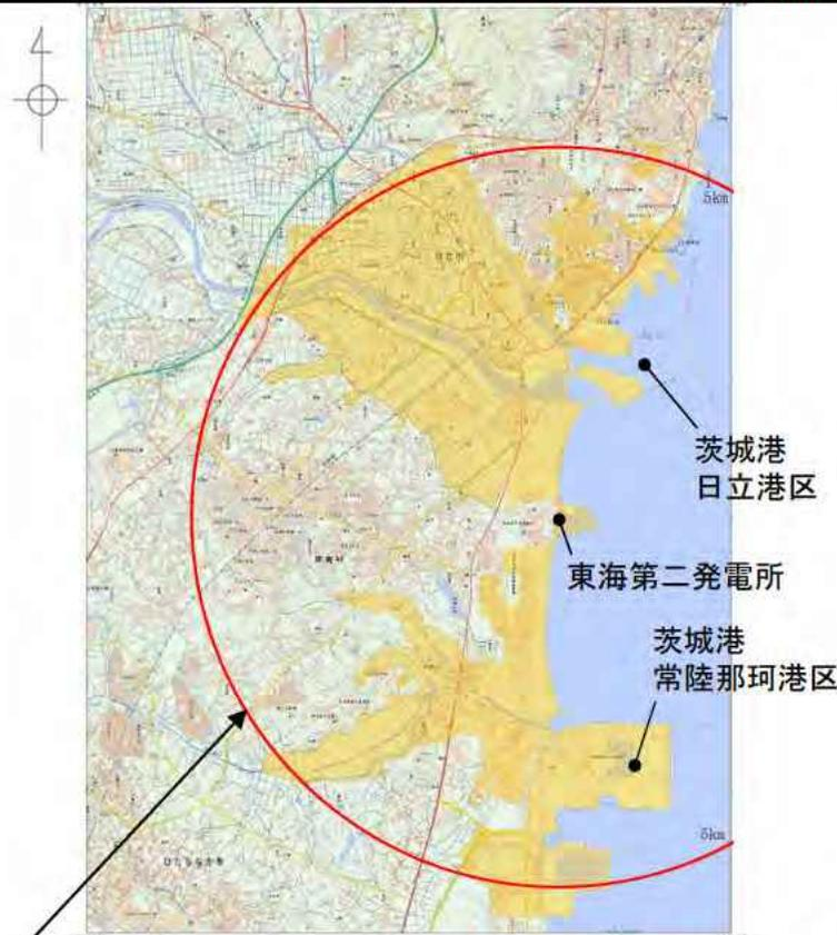
調査範囲は、津波のシミュレーション結果を踏まえて、津波の流向・流速から、漂流物が発電所へ向かって移動する可能性のある距離を評価した結果が約3.6kmとなったことから、漂流物の移動距離より大きくなるように設定し、**発電所から半径5kmの範囲**とした。
