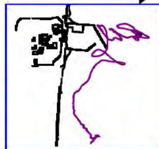
●基準津波による漂流物の軌跡と北方から襲来する津波による漂流物の軌跡を比較(防波堤なし)
