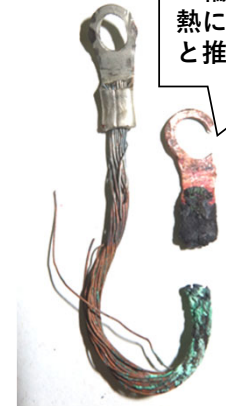
電磁接触器（MC1）－サーマルリレー（OLR1）間のケーブル
