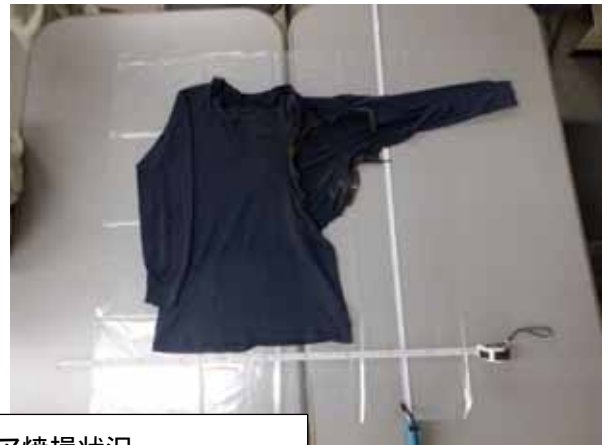
インナーウェア焼損状況 (左上腕, 左胸部にかけて焼損, 焦げ跡を確認)
