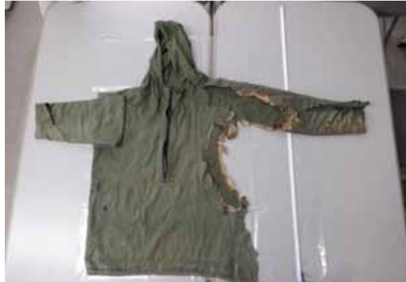
耐火服焼損状況 (左上腕, 左胸部～左背中にかけて焼損, 焦げ跡を確認)
