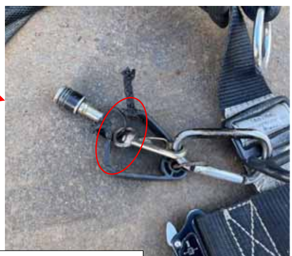
フルハーネス焼損状況 (ホルダの一部が溶け落ちていることを確認)
