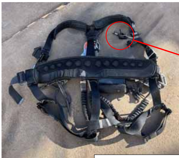
フルハーネス焼損状況 (ホルダの一部が溶け落ちていることを確認)
