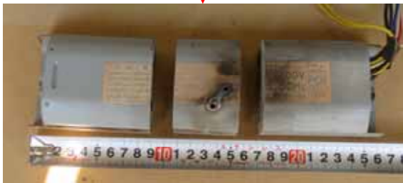
当該安定器 (原因調査のため切断)
