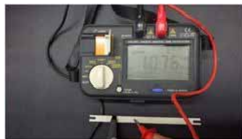
抵抗試験（湿状態）1.1MΩ
