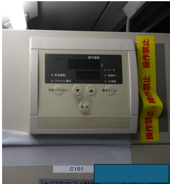
写真 4-1 発災した恒温槽のコントローラ電源スイッチ電源断の状況
