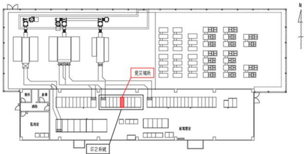
図3 50GeV 変電所内の高圧配電盤の設置
