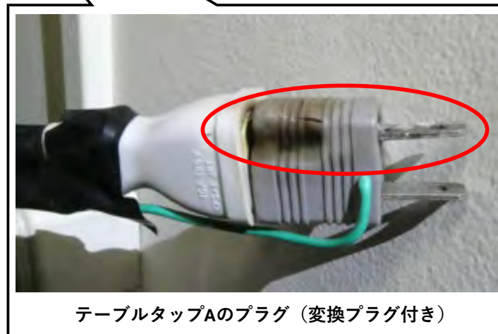
テーブルタップ、床コンセント及び電気機器の配置並びに焦げ跡の状況
