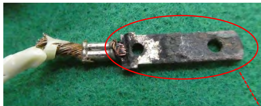
プラグ分解後 (焦げ跡がある側の栓刃)
