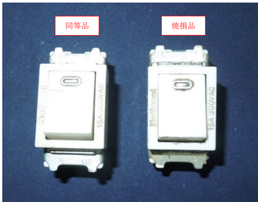
図7 照明スイッチの外観（焼損したスイッチとそれと同等のスイッチとの比較、左：表面、右：裏面）
