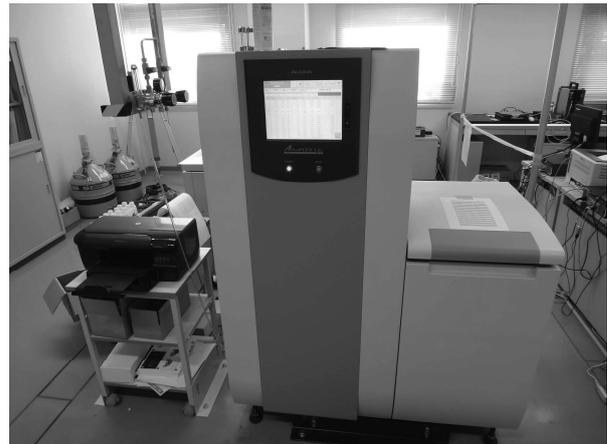
図2 低バック液体シンチレーションシステム
