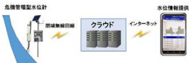
図 1 水位計測とクラウド構成
