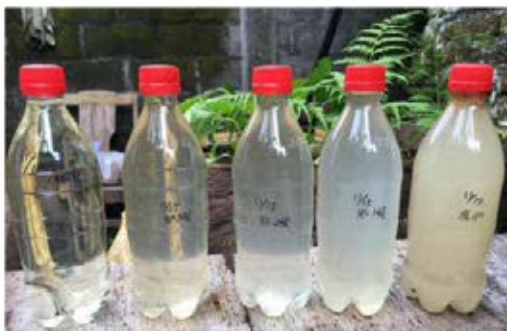
図4 原水と各段通過の処理水の外観
