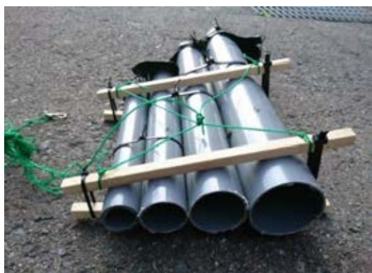
図 2 製作した塩ビ管トラップ
