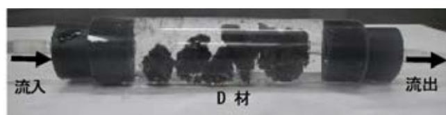
写真 1 D 材を封入したカラムテスト
