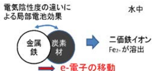
図 1 鉄イオン Fe 2+ 溶出のメカニズム
