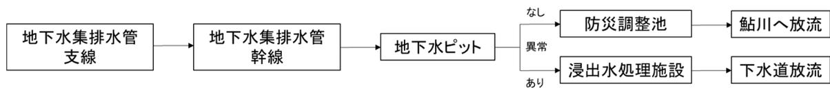
図 4.35 地下水集排水の流れ
