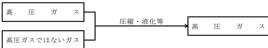
冷凍設備の中では、冷媒ガスが圧縮・液化されているので、高圧ガスの製造施設となります。
