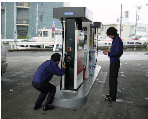
燃料油メーター立入検査
