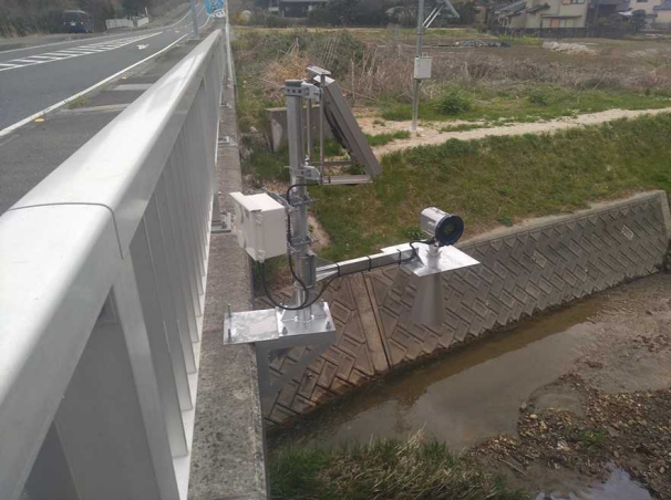
危機管理型水位計の設置イメージ
