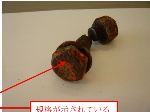
写真 2.4.4 F11T 遅れ破壊破断
