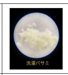
洗濯バサミは、紫 外線劣化し, 粉末 状のプラスチックが 見られた。壊れや すく、プラスチック がもろくなっていた。
