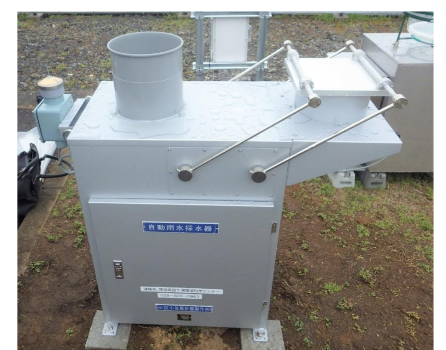
湿性降下物の採集器 (小笠原計器製作所 US-330)
