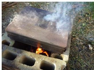
準備品は、ブリキ製の蓋付き容器（中央に穴をあける）とブロック3枚。約15分程度でブリキ容器の隙間から白煙が出始め、時間経過すると煙が変色する。
