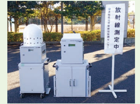
代替用の可搬型モニタリングポスト 測定設備が欠測した際の代替用測定器
