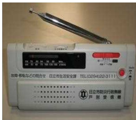
図 防災行政無線戸別受信機（日立市HPより）
