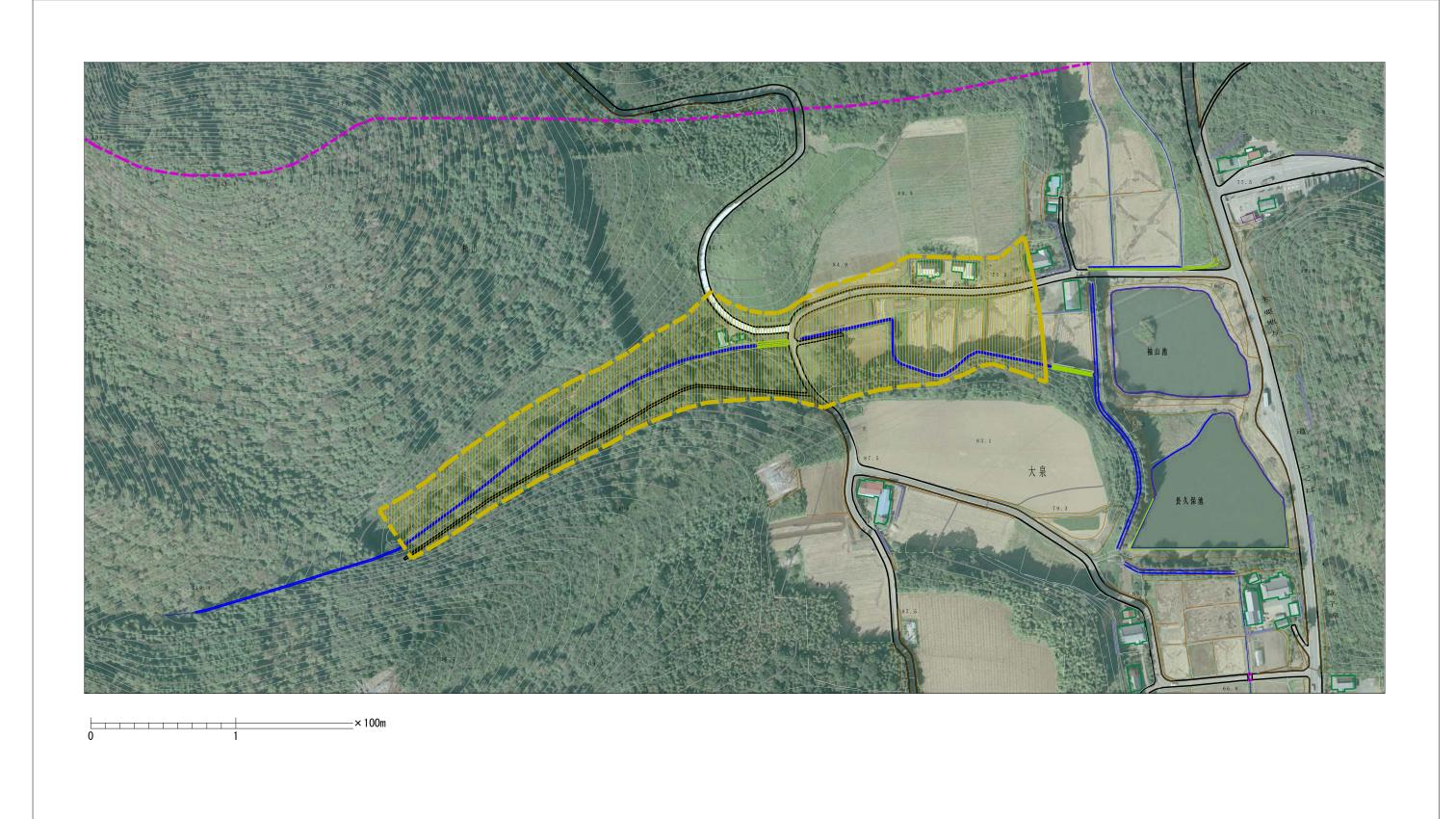
自然現象 の種類 様式-2(土) 土砂災害防止法施行令第二条の基準に該当する区域 土石流 渓流番号 | 324- Ⅱ -008 土石流の高さが1m超える場合、土石等の 移動による力が50kN/㎡を超える区域 土砂災害警戒区域·土砂災害特別警戒区域 土砂災害防止 法施行令第三 矢の基準に該 当する区域 土石流の高さが1m超える場合、土石等の 移動による力が50kN/㎡以下の区域 告示番号 茨城県告示第200号 渓流名 袖山北沢 区域図 1:2,500 告示年月日 平成25年3月7日 所在地 茨城県桜川市大泉 それ以外の区域
