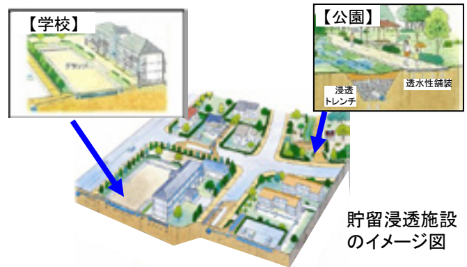
▲つくばエクスプレス沿線開発の貯留浸透施設整備
