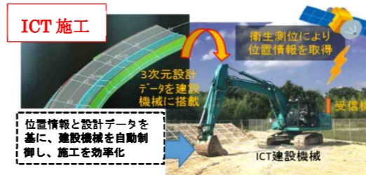
図4 ICT施工のイメージ
