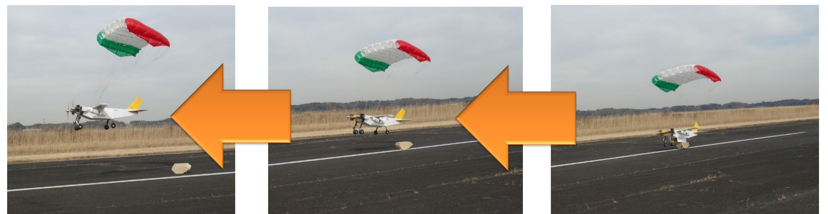
物資運搬コンテナの自動切り離し
