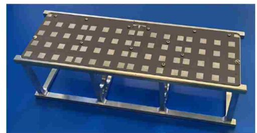
図1 アレー方式アンテナ
