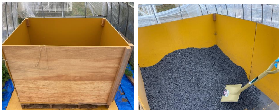
図1 簡易脱臭槽 (左: 外観、→: 内部)
