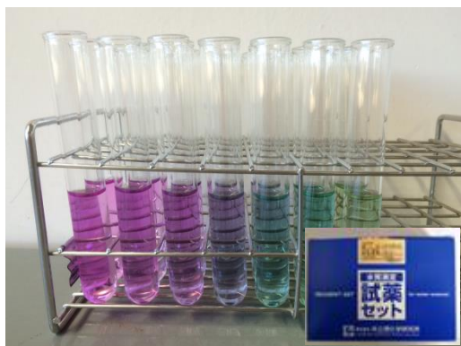
図1 市販の水質測定試薬セットを用いた土壌抽出液のCODの測定
