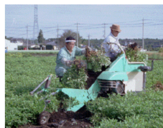
カンショ収穫機による 掘取・反転作業(5.0h/10a)
