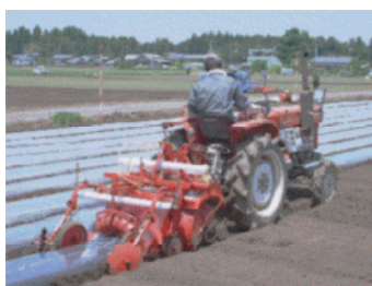
ポテトプランタによる マルチ敷設作業(3.2h/10a)
