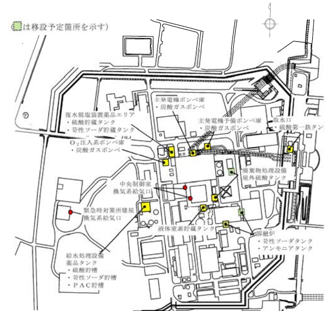
屋外設備の貯蔵箇所
