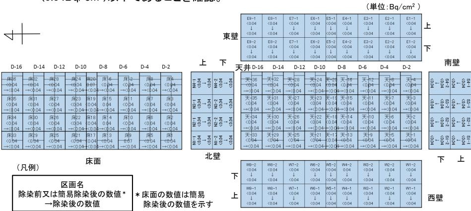
粉末調整室(A-103)の床面、天井及び壁の除染前後の表面密度
