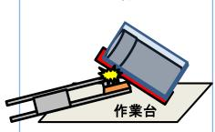
熱溶着装置先端部 との接触イメージ
