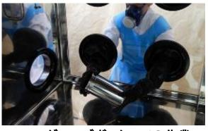
「グローブボックス」とは、核燃料物質をボックス内に閉じ込めて作業する設備のこと。 グローブボックス内の作業を、 左図のように手袋を介して行う。
