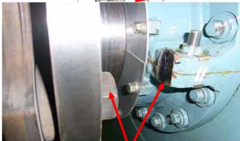
コプフレックスカップリングのボルトが交流励磁機外側油切りに接触
