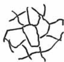
① 表面ひび割れ
