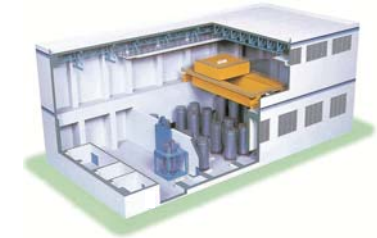
②使用済燃料乾式貯蔵施設
