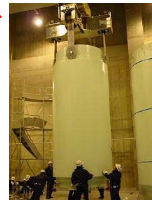
⑤ 乾式キャスクの移動作業
