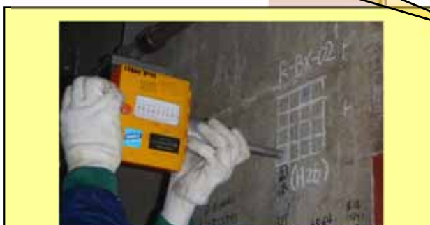
非破壊試験結果による点検箇所を選定 (リバウンドハンマー試験による表面状態の確認)
