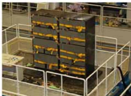
可搬型設備の加振試験
