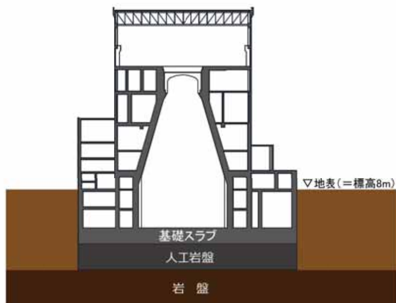
原子炉建屋の設置状況図
