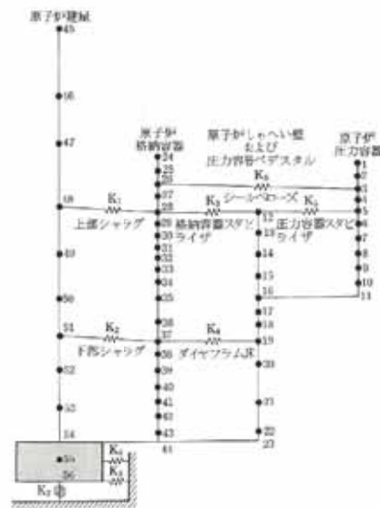
試験体解析モデル(水平方向)
