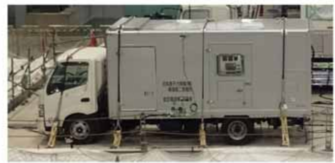
(a) 機能確認加速度確認のための加振試験状況
