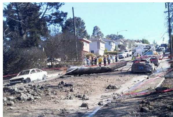
爆発地点のクレーターと破断した配管 論点No.59-21
