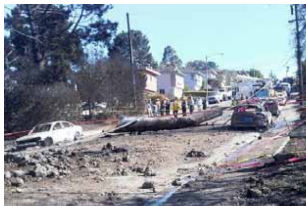
爆発地点のクレーターと破断した配管 外部事象 -172
