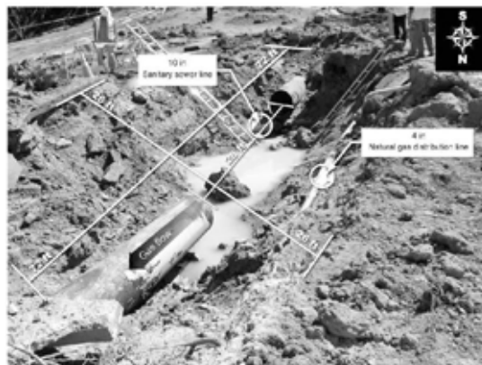
爆発地点のクレーターと破断した配管 外部事象 -172
