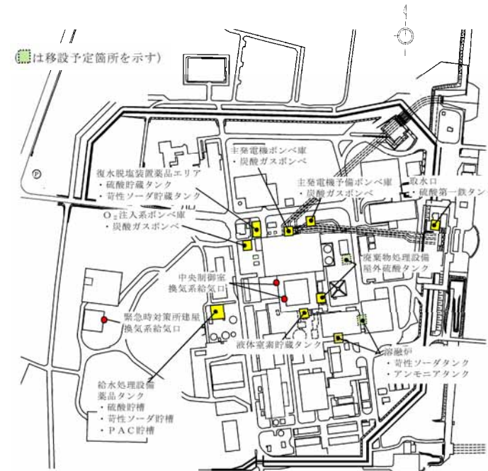
屋外設備の貯蔵箇所
